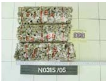
Prüfkörper der Kernbohrungen
