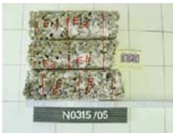
Prüfkörper der Kernbohrungen
